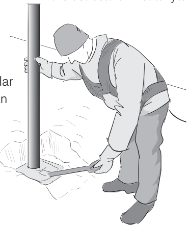
Stick in en spade under röret. Lyft upp det och väg snöinnehållet.
