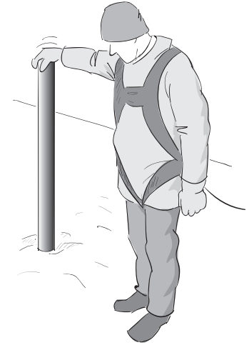
Stick ett rör genom snön tills det bottenar mot takytan.
