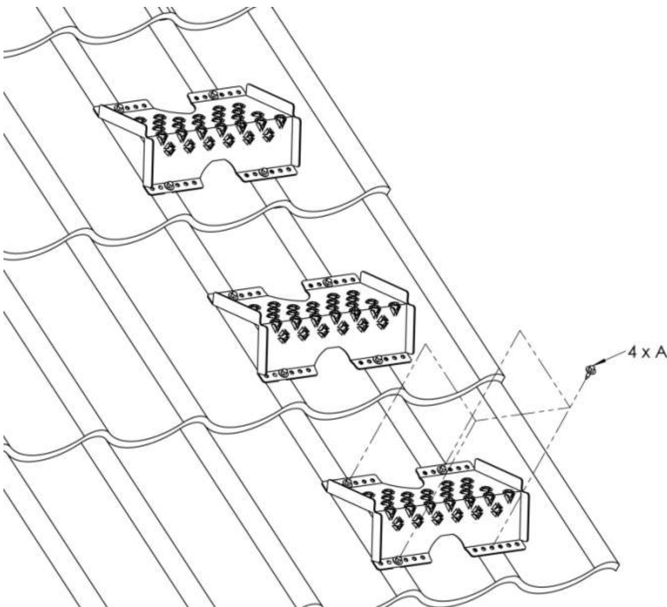
**A= Rostfri plåtskruv med bricka 19 x 6,3 mm**
